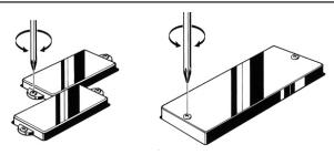
\*Bei Instrumenten mit einstellbaren Polstücken kann die Ausgangssignalstärke jeder Saite eingestellt werden.
