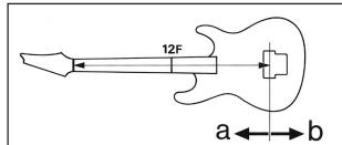
て、それぞれの弦の12フレットを押さえた時の音と、12フレット上のハーモニクス音がおよそ等しいかどうかを判断する方法が一般的です。ハーモニクス音を基準として、フレット音が低い場合はブリッジサドルを前方（ヘッド側）へ移動させて弦長を短くします。逆にフレット音が高い場合は、ブリッジサドルを後方（ヘッド側と逆方向）へ移動させて弦長を長くします。
