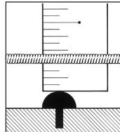
弦高調整はブリッジ本体またはブリッジサドルの高さを変化させて調整します。また、ネック調整やゲージの異なる弦への交換後も弦高の再調整が必要です。
