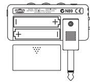
Quita la tapa del compartimento de las pilas. Inserta dos pilas tamaño AAA como se muestra en figura. Asegúrate de que la polaridad es la correcta. Si vas a usar el **amPlug** durante un periodo largo de tiempo te recomendamos que uses pilas alcalinas. Reemplaza las pilas cuando el indicador se oscurezca.
