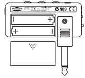
Entnehmen Sie die Blende des Batteriefachs. Legen Sie zwei AAA-Batterien wie in der Abbildung gezeigt ein. Beachten Sie beim Einlegen die Polarität. Wenn Sie den **amPlug** längere Zeit am Stück verwenden möchten, sollten Sie sich für Alkalibatterien entscheiden.
