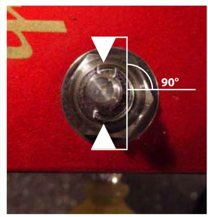
SCREW OFF THE LOCK NUT AND MAKE SURE THAT THE RECESS IS AT AROUND 90 DEGREES TO LONGITUDINAL DIRECTION OF THE NECK. YOU CAN TURN MANUALLY ON THE KEY OR BY STRING UP MODE (PAGE 11)
