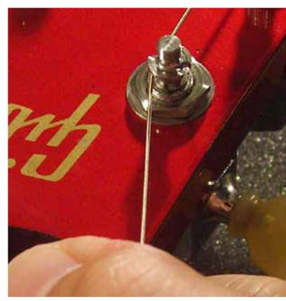
PULL TIGHT ON THE STRING TO GET PRETENSION AND BEND IT ONE HALF TURN AROUND THE BOTTOM SIDE OF THE STRING SHAFT.
