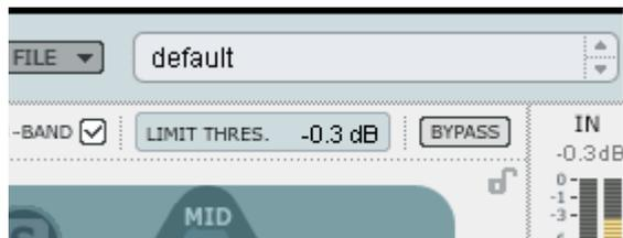
El Fabrik C también dispone de un limitador. Este limitador se usa para evitar las sobrecargas que se producen en los valores extremos y picos ocasionales del material fuente - picos que no pueden ser capturados y atenuados de forma suficiente por el compresor. Dado que puede usar este limitador para controlar esos valores extremos, podrá usar el compresor para aplicar una compresión mucho más sutil y “musical”.
