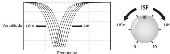
Wir empfehlen, dass der ISF Regler am Anfang auf die Mitte eingestellt wird und dass die Bass- Middle- und Trebleregler nach Geschmack eingestellt werden. Dann versuchen Sie allmählich, den ISF nach rechts und nach links einzustellen, bis Sie Ihren bevorzugten Klang erhalten.
