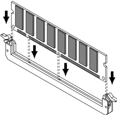
\* Si vous éprouvez de la difficulté à insérer le module de mémoire, inclinez-le légèrement et insérez une extrémité à la fois.
