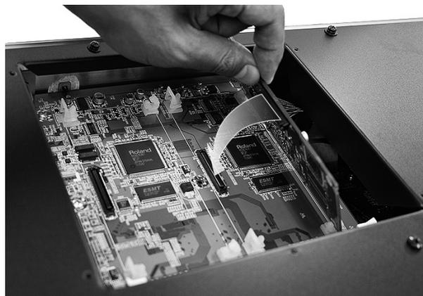
\* Ne jamais user de force excessive pour installer une carte de circuits imprimés. Si elle ne s'ajuste pas adéquatement au premier essai, la retirer et essayer à nouveau.
