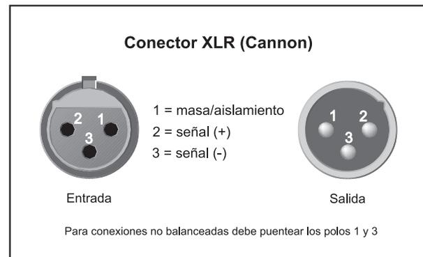
Fig. 4.1: Conexiones XLR
