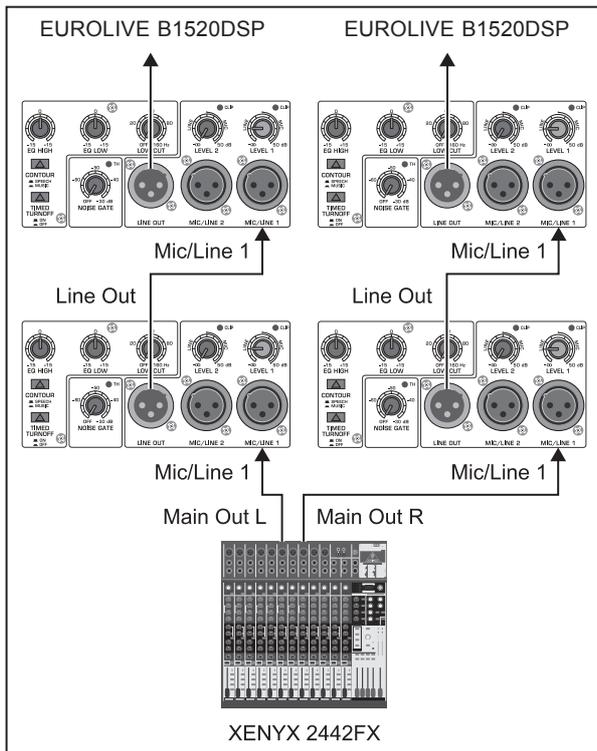
Fig. 3.3: Conexión en serie de varios B1520DSP
